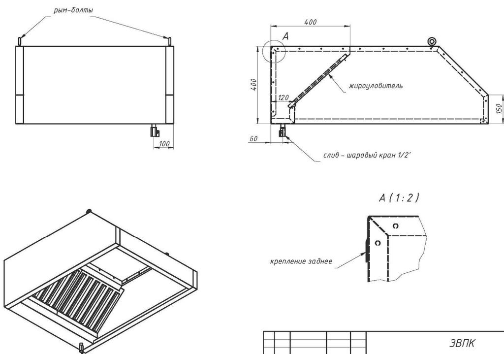
**\*ШИРИНА ЗОНЫ ВЫТЯЖКИ ЗОНТОВ ЗВПК - 400ММ**
