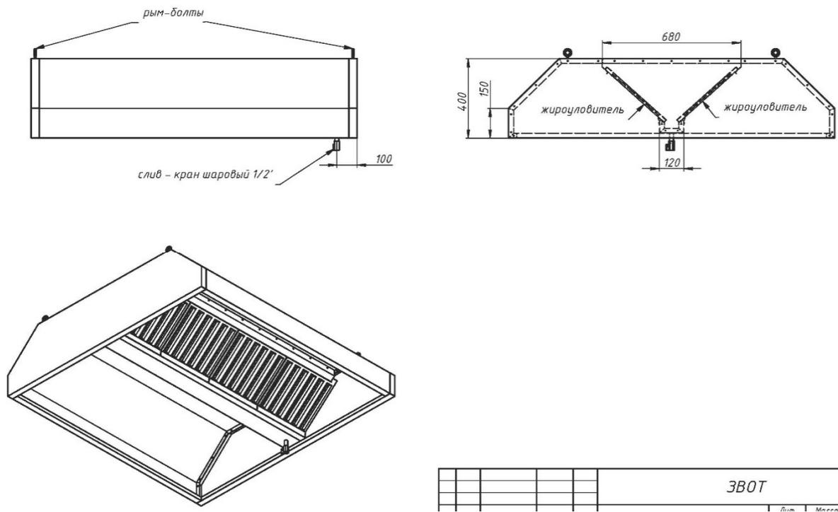
**\*ШИРИНА ЗОНЫ ВЫТЯЖКИ ЗОНТОВ ЗВОТ - 680ММ**
